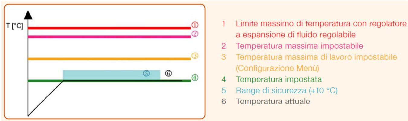
Il regolatore PID permette una facile impostazione di tutti i parametri di funzionamento ed un ottimo controllo tramite microprocessore della temperatura. Il numero limitato di tasti di regolazione dei parametri garantisce un'operatività estremamente semplice ed intuitiva.
